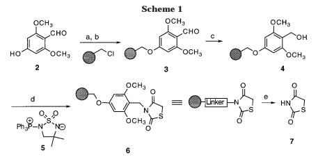
Key: (a) NaH/DMF; (b) Merrifield resin, 50 °C, 36 h; (c) NaBH<sub>4</sub>/THF/rt/24 h; (d) 2,4-thiazolidinedione, betaine (5),  $CH_2CI_2/rt$ ; (e) TFA/H<sub>2</sub>O/triisopropylsilane (TIS).
